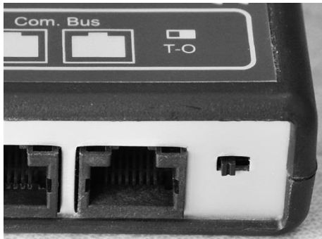
Xcom-232i-Terminierung aktiviert (T-Stellung)
